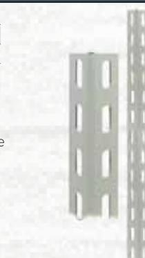
In lamiera di acciaio pressopiegata con rivestimento superficiale di finitura verniciato con polveri epossidiche. Spessore 1,8 mm. Dimensione 35x35 mm. Portata max per angolare 350 kg.
