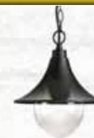
Struttura in pressofusione di alluminio, trattamento anticorrosivo, verniciatura a polveri epossidiche. Diffusore in termoplastica trasparente. Portalampade E27. Alimentazione max 100W. Grado di protezione IP44. Dimensioni mm.260x355x442h.
