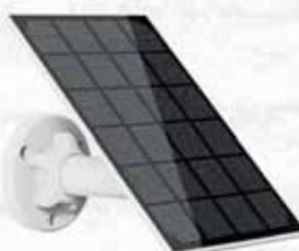
Compatibile con qualsiasi fotocamera alimentata da batterie a 5V, 1A CC. Cavo Micro USB, risparmio energetico, resistenza alle intemperie, eco-sostenibile. Lunghezza del cavo (micro-USB): 2,50 m. Temperatura di funzionamento: -20,5/48,5 °C.
