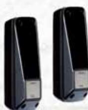
Fotocellula da parete orientabile. Tensione di alimentazione: BUS 2easy, a 2 fili non polarizzati 24V. Distanza max fotocellule 20 mt. Grado di protezione IP54. Angolo di autoallineamento  $\pm 7^\circ$  (20 m)  $\pm 13,5^\circ$  (5 m). Angolo di orientamento orizzontale:  $-90^\circ$   $+90^\circ$ . Corrente assorbita: Rx (10 mA) + Tx (10 mA). Temperatura ambiente di esercizio:  $-20^\circ\text{C} \div +55^\circ\text{C}$ .
