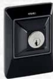
Pulsante a chiave e di comando. Tipologia di installazione: a parete o su colonnetta. Microinterruttori in scambio: 1. Portata contatti: 100 mA. Grado di protezione IP54. Temperatura ambiente di esercizio: -20°C/+55°C.
