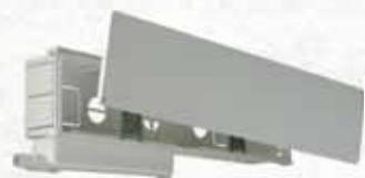
Realizzata in materiale plastico. Completa di coperchio e Sifone meccanico incorporato nella vaschetta. 3 possibilità di scarico: dx, sx, centrale. Tasca di raccolta reversibile con portagomma Ø 18÷20. Prodotto Brevettato.
