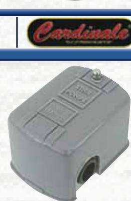
Campo di regolazione 1,4÷4,6 bar. Svolgono la funzione del controllo automatico dei livelli di energia di pressione agendo sull'alimentazione dell'elettropompa. Attacco con dado girevole.
