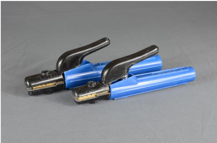
ALMA è una pinza serra elettrodo a coccodrillo "entry level" per amperaggi medio alti, disponibile nelle due versioni ALMA 350 e 500 rispettivamente da 350 e 400 A (35%). ALMA è realizzata con corpo in ottone ed impugnatura in robusto materiale plastico antiurto ed isolante. Due viti con cava esagonale provvedono al fissaggio del cavo al corpo.
