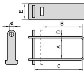
CRAVATTE - INDICATE PER: LUCCHETTI CORAZZATI FAI BY VIRO, PANZER, PANZER INOX, PANZER PREDISPOSTI PER MEZZO CILINDRO E MONOLITH (I LUCCHETTI CON ASTA DIAMETRO ≥ 12 MM SONO UTILIZZABILI SOLO CON ART. 677)
