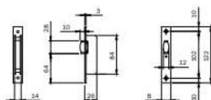
Serratura da infilare per montanti a scatola aperta. Frontale in ACCIAIO CROMATO.
