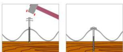
Per il fissaggio di coperture ondulate, su supporti lignei.
