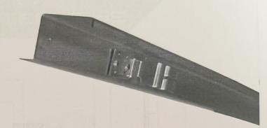
Telaio perimetrale realizzato in lamiera zincata con spessore 12/10, in profilato a Z per facile posa in opera. E' dotato di sei zanche di ancoraggio facilmente orientabili in qualsiasi direzione. La soglia inferiore è asportabile con un semplice cacciavite, anche a telaio già murato.
