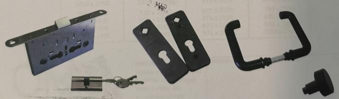
In confezione a parte sono fornite maniglie e placche realizzate in nylon, colore nero opaco e un cilindro in ottone tipo "Yale" con tre chiavi.
