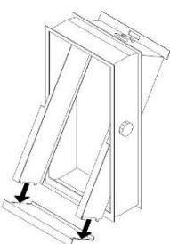
Il vetromattone trova spazio all'interno mediante la rimozione momentanea dell'aletta metallica inferiore del serramento, dopo di che si deve procedere con la normale posa utilizzando la malta apposita per vetromattone.
