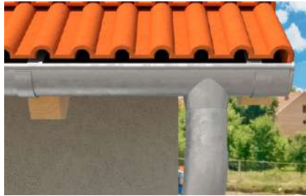
Posizionamento di tegole e coppi.
