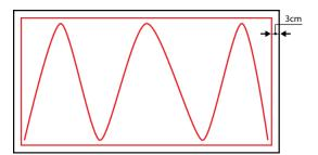
Attendere da un minimo di 2 ad un massimo di 8 minuti (20°C / 65% U.R. - questo tempo è più breve a temperatura/umidità più elevate e più lungo a temperatura/umidità più bassa) e successivamente premere il pannello isolante contro il muro. Lavora dal basso verso l'alto senza spazi vuoti. I pannelli isolanti devono essere incollati sfalsati negli angoli esterni degli
