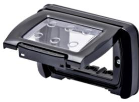
Placche stagne IP55 serie System per fissaggio su scatole rettangolari (3 e 4 posti). Placche stagne autoportanti per l'installazione di dispositivi System. Membrana ergonomica, apertura agevolata da una comoda impugnatura. Grado IP55 garantito a coperchio chiuso e con montaggio su pareti lisce, impermeabili e senza scanalature.
